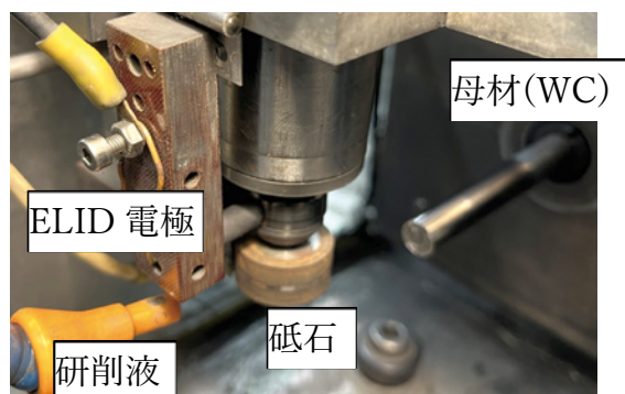
図2 ELID研削システム
