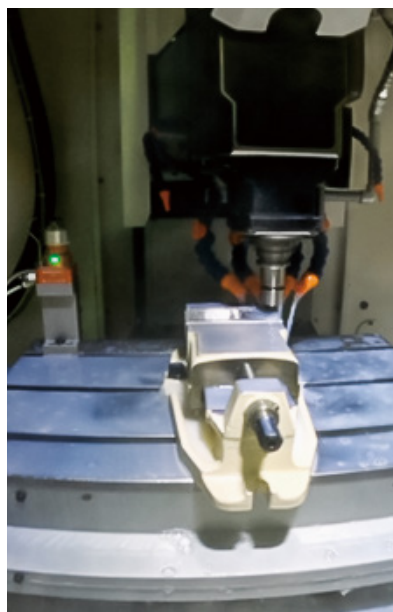
図 7 マシニングセンタ (FANUC社ROBODRILL)
