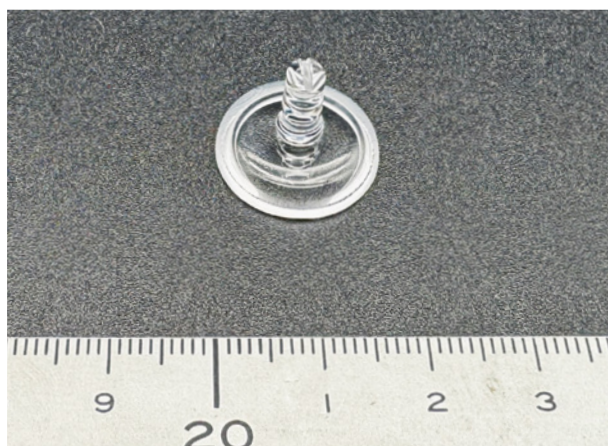
石英ガラス製支柱付きサンプルポート
