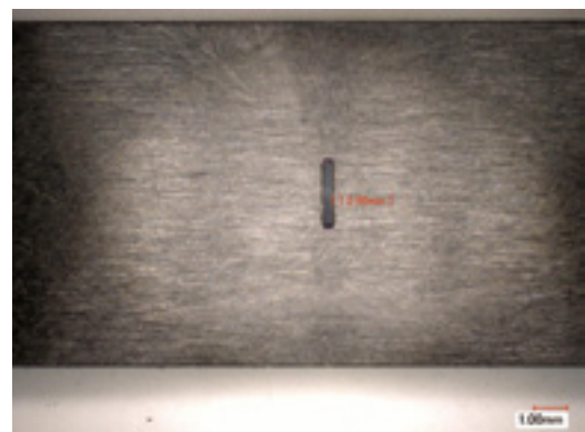
Fig.13 スリット加工の例 (幅0.3mm)
