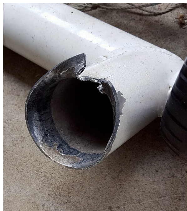
図12 破損したサッカーゴール
