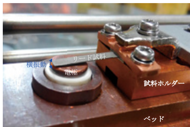
図2 内部摩擦測定用ベッド及び銅製試料ホルダーに固定された薄板リード試料(長さ約15mm、幅2mm、厚さ0.2mm)。ベッドから電氣的に絶縁された電極から約0.1mm離して、対向するようにリード試料を設置することで、コンデンサが形成される。電極と試料間の間隔が変わるとコンデンサ容量が変化することを利用して、試料の振動状態を計測する。異なる形状の試料に対応できるように、試料ホルダー位置や電極高さは可変となっている。写真に写っているベッドや試料ホルダーの加工、薄板状試料切り出しなど、多くの作業を工作部門機械工作室に依頼している。
