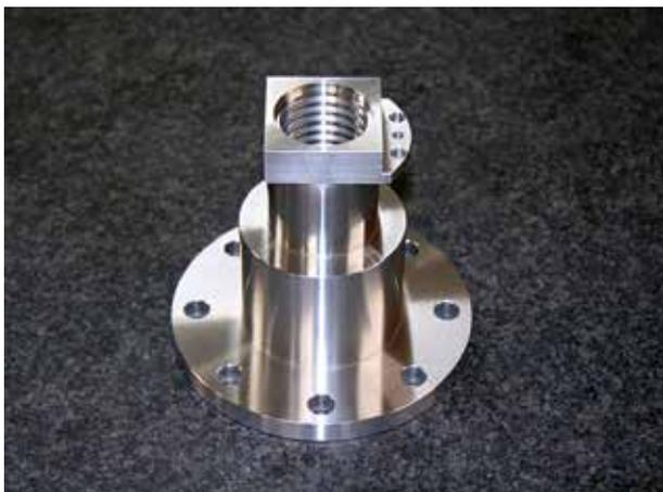
低電力試験用導波管
