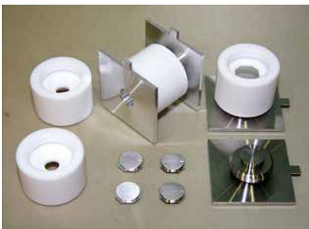
熱電測定用液体セル
