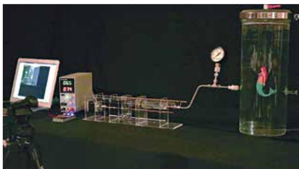
図4 浮沈子をPID制御している様子
