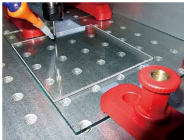
図11 工作物の固定作業
