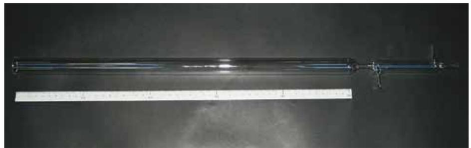
水冷ジャケット付き燃焼管 (石英製)
