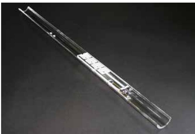
管状炉内試料ガイドレール (石英製)
