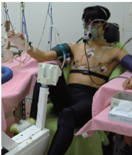
図1 実験の様子(被験者はCGタイツを着用してセミリカンベント姿勢での自転車運動を行った。右上腕部分において静脈閉塞プレチスモグラフィにて血流測定を行った。他に、呼気ガス分析、血圧、体温、心拍数、発汗量などを測定した。)
