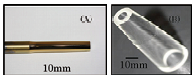
図2 金型母材(A)とウォルターミラー(B)
