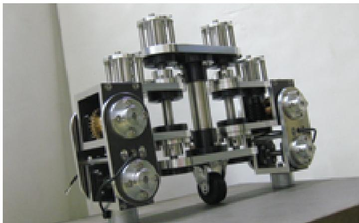
図3. 移動ロボット(モータ無し)
